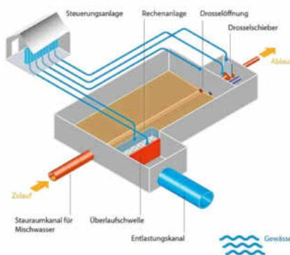
Modelldarstellung eines Stauraumkanals und seiner Funktionsweise
